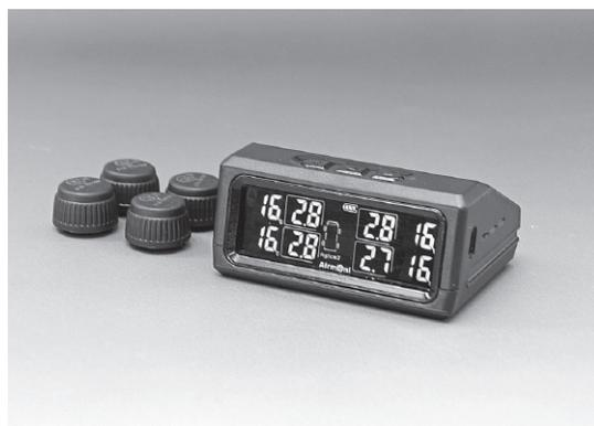
シリーズのトップモデルとなる「エアモニ4」は、バルブキヤップを外してセンサーを取り付けるだけで、最大約10kgf/平方cmのタイヤ空気圧が計測できる。大型ディスプレイの採用で、4輪車のほかダブルタイヤやトレーラにも対応し、最大8輪車まで同時表示が可能だ。レシーバーはソーラー充電が可能で完全ワイヤレスで運用でき、リアルタイムのデータ更新により、車室内のディスプレイで空気圧と温度を常時確認できる。重量はレシーバーが約110gでセンサーが約9g。サイズはレシーバーが高さ40mm×幅88mm×奥行66mm、センサーが直径23mm×高さ16・5mm。価格は4輪用が2万7000円、6輪用が3万7000円、8輪用が4万6000円（いずれも税別）。プロテクタグループや自動車用品販売店、インターネットで販売する。
