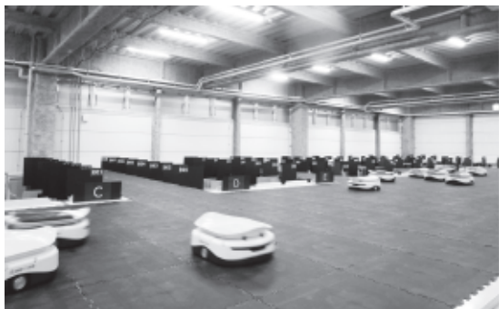
中量棚の上でロボットを稼働
