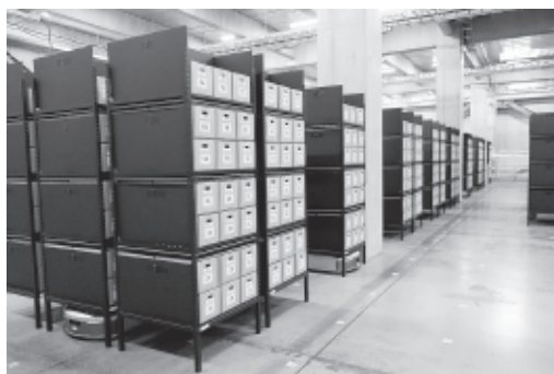
EVEで保管棚を自動搬送
