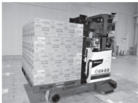
荷役作業中のAGF（山陰支店）
