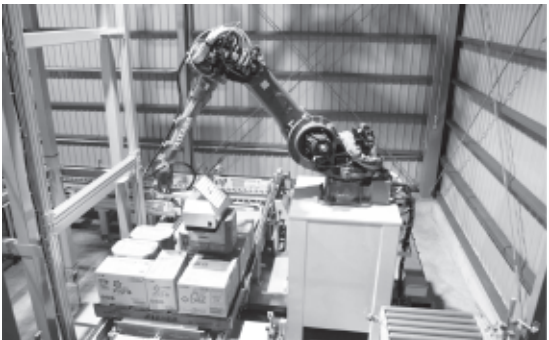
物流センターに導入したデパレタイズロボット
