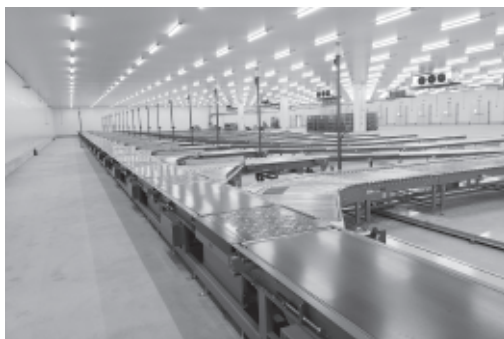
荷捌き棟の高速ソーター
